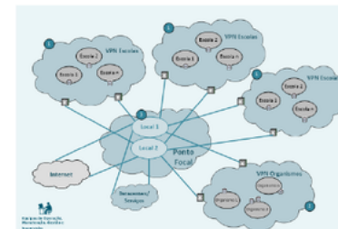
Figura 4. Arquitetura das ligações das escolas à VPN Fonte: LAN – Redes de Área Local nas Escolas, DGEEC, ME, 2009
